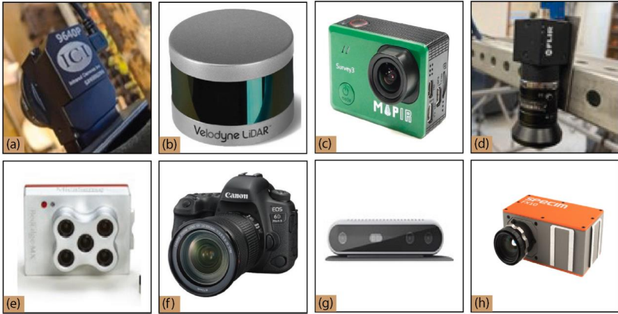
Şekil 4. Yabancı Ot Tespiti İçin Kullanılan Popüler Görüntüleme Sensörleri:(a) termal kamera, (b) LiDAR, (c) kamera (MAPIR), (d) Teledyne FLIR kamera, (e) Multispektral Kamera, (f) RGB kamera, (g) Derinlik kamerası, (h) Hiperspektral Kamera.
