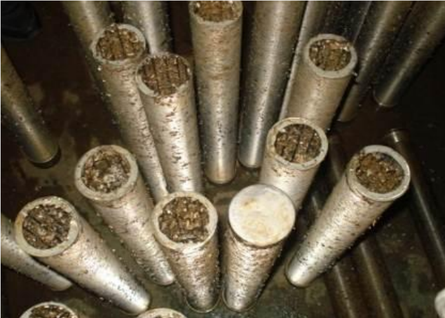
Şekil 4. Borularda biriken Zebra midyeler (DSİ, 2012)
