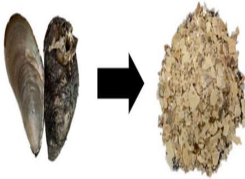
Şekil 3. Midye kabuklarının çimento katkı maddesi haline getirilmesi (de Freitas ve ark., 2024)
