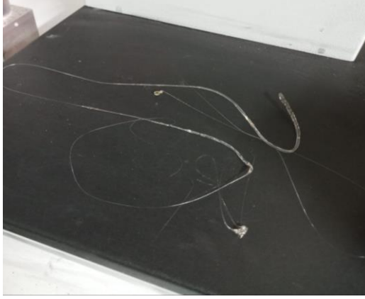
Şekil 6: Deniz yosunu ve nişasta karışımına sahip malzemenin MFI testini geçememe görüntüsü
