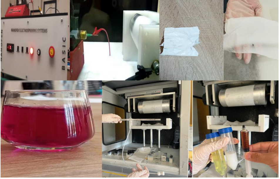
Şekil 11: Nanofiber membranların elektroçğirme tekniğıyle elde edilme aşamaları
