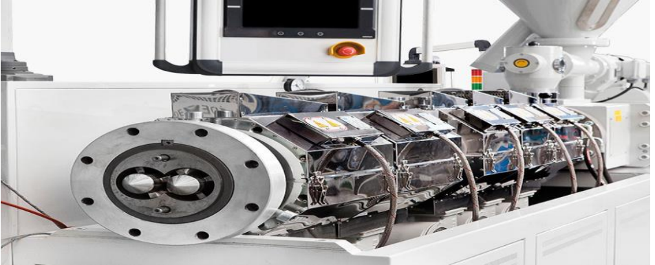
Şekil 4: Çift vidalı ekstrüder görüntüsü ( https://limaextrusion.com/tr/projects/granul-ekstruzyon-paralel-cift-vidali-ekstruder/ )
