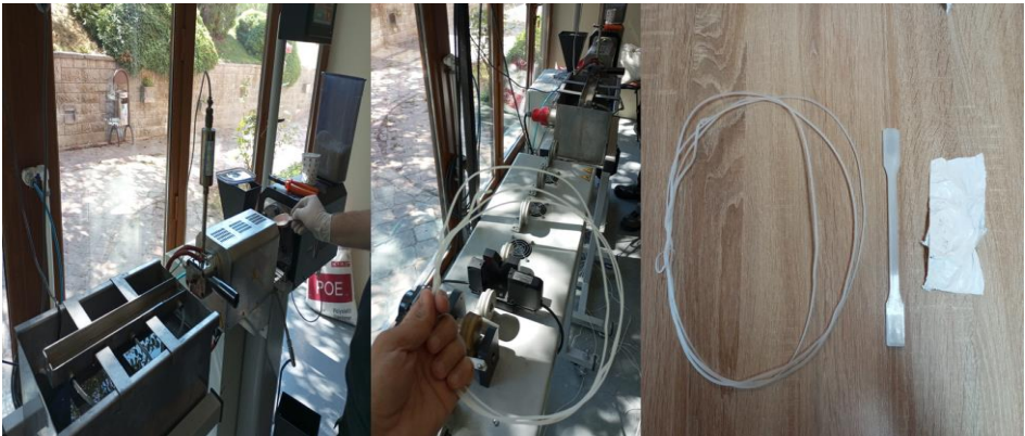
Şekil 9: Tek vidalı ekstruder kullanımı ile 3 boyutlu yazıcılar da kullanılmaya uygun filament üretim aşamaları
