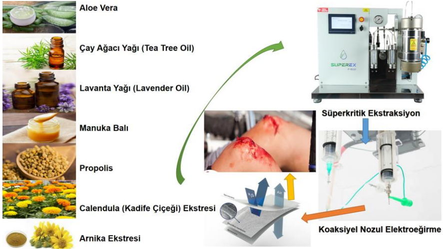
Şekil 2: Bitkilerden süperkritik ekstraksiyon ile etken madde ayrıştırma, etken madde içeren yara örtülerinin koaksiyel nozul içeren elektroğirme tekniği çalışma görüntüsü
