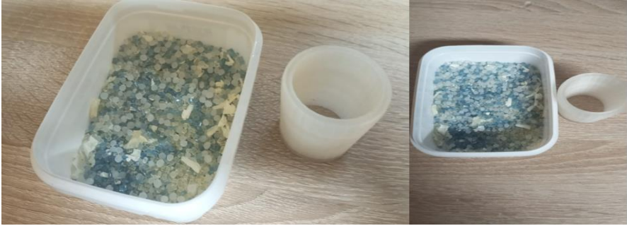
Şekil 8: Çift vidalı ekstruder de kompozit granül elde edilme aşamaları
