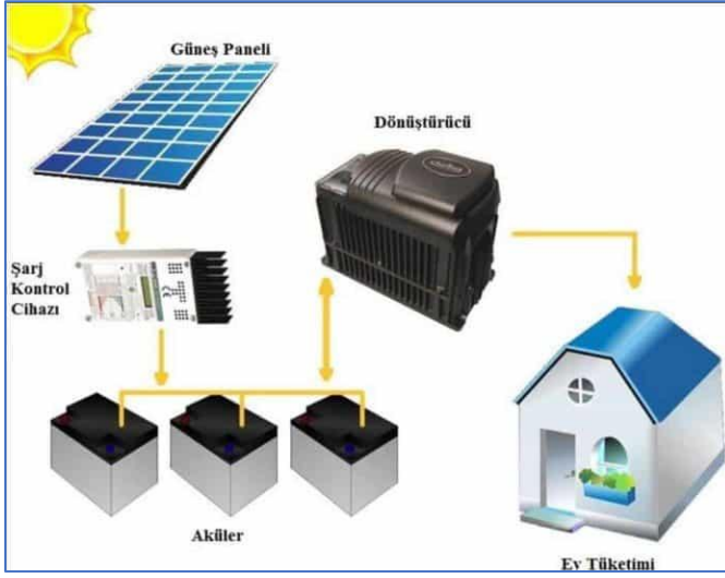
Şekil 1. Fotovoltaik sistem bileşenleri
