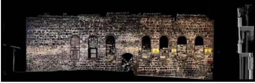
Şekil 2.13 Kuzey cephesi (3d lazer tarama verisi)
