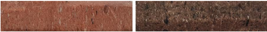
Görsel 5. 1000°C ve 1200°C, Sırsız Pişirim, Vişne Renkli Nevşehir Doğal Taşı, Özkapadokya. Fotoğraf: Betül Aytepe Serinsu.
