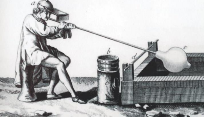
Şekil 3: Cam malzemelerin şekillendirilmesi sırasında kullanılan koruyucu gözlükler (Erdal, 2022).
