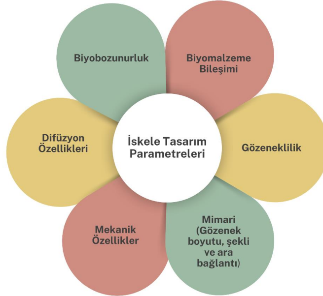
Şekil 1. İskele tasarımı için gereksinimlerin şematik gösterimi (Giannitelli vd., 2014)
