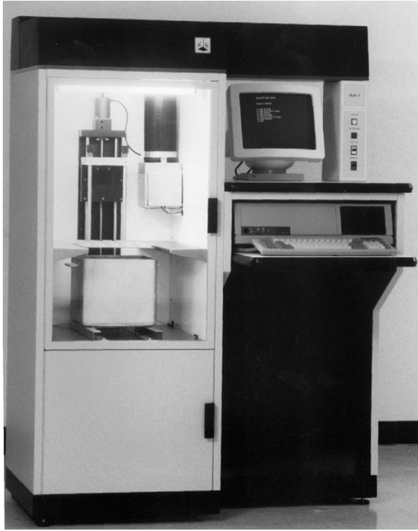
Şekil 1. İlk stereolitografi 3B-yazıcı, (Hull, 2015)
