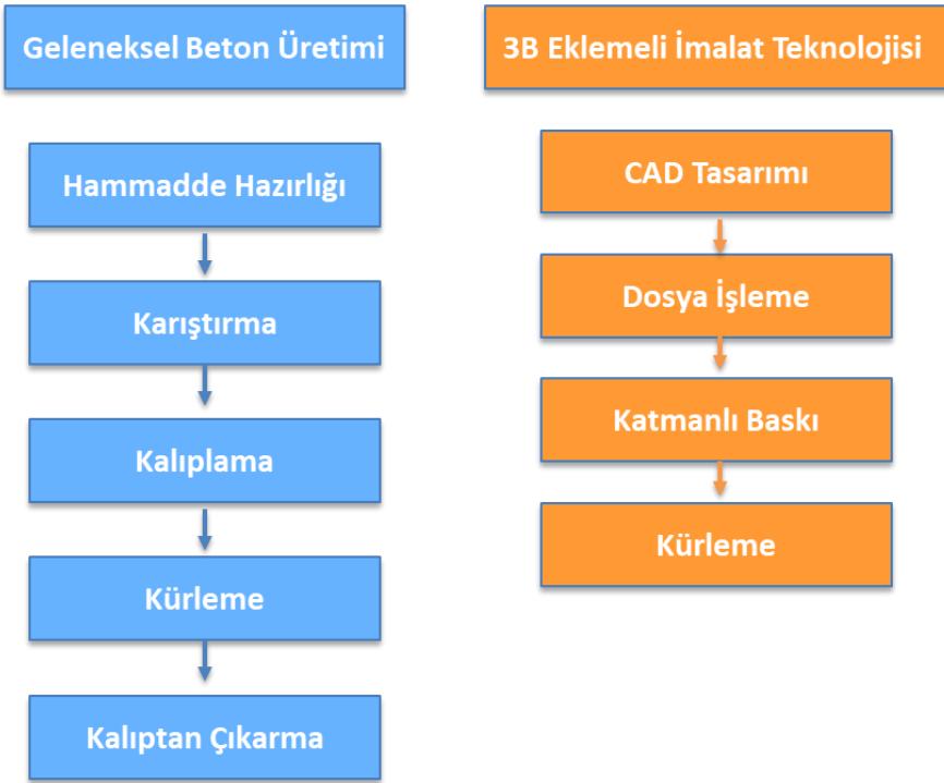
Şekil 5. Geleneksel beton üretimi ve 3B eklemeli imalat teknolojisi üretim süreçleri.
