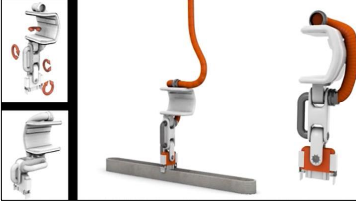
Şekil 2. Kontür işleme makinesinin nozülleri (Khosnevis, 2004; Khorramshahi ve Mokhtari, 2017)
