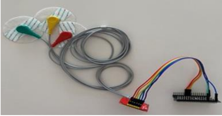
Şekil 7 : EKG Sensörü ve ESP32 Bağlantısı
