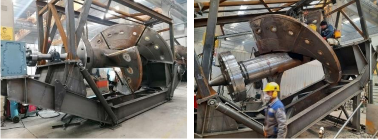
Şekil 1. Tasarlanmış olan Tozaltı Helezon Kaynak Tezgâhı (VTM) (Birikim Mühendislik Tasarım Merkezi)
