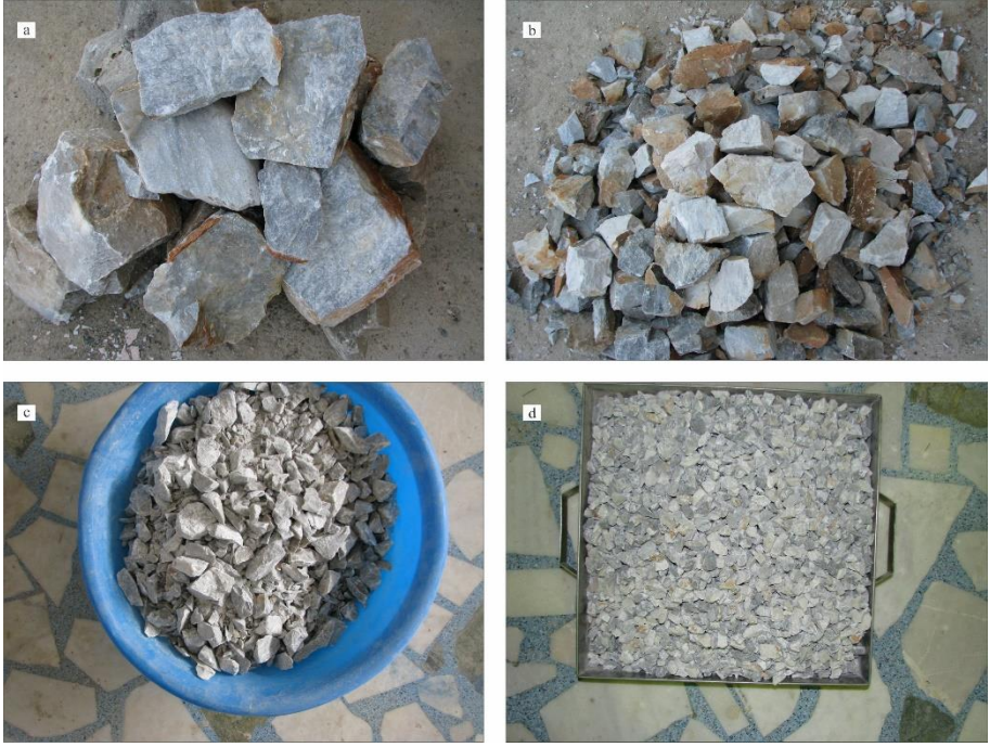
Şekil 1. Mermerlerin boyutlandırılması ve agrega numunelerinin hazırlanması
