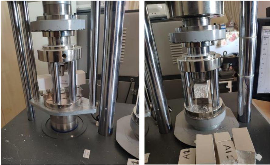
Şekil 5: Alçı numunelerin üç nokta eğilme (solda) ve basınç dayanımı (sağda) deneyleri
