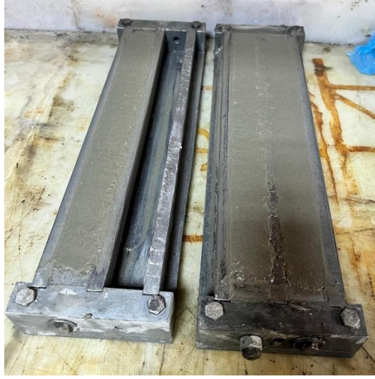
Şekil 6. Harç çubuklarının kalıba yerleştirilmesi
