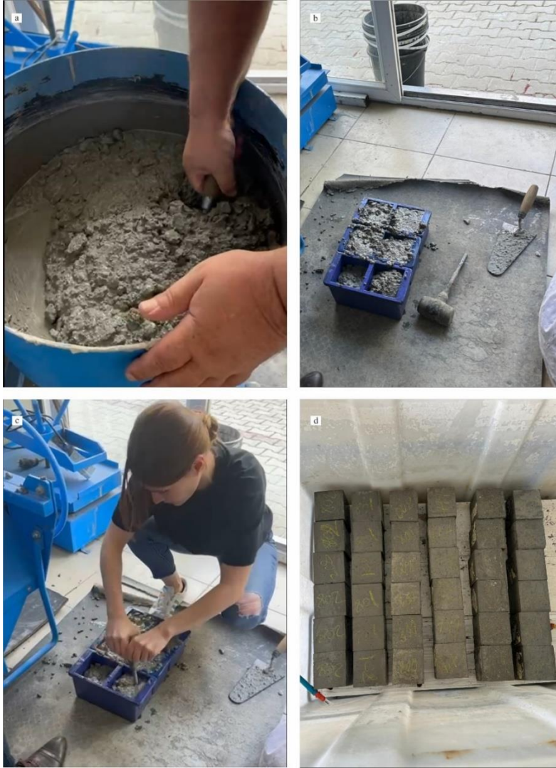
Şekil.5 Beton hazırlanması, betonun kalıplara yerleştirilmesi ve kürlenmesi
