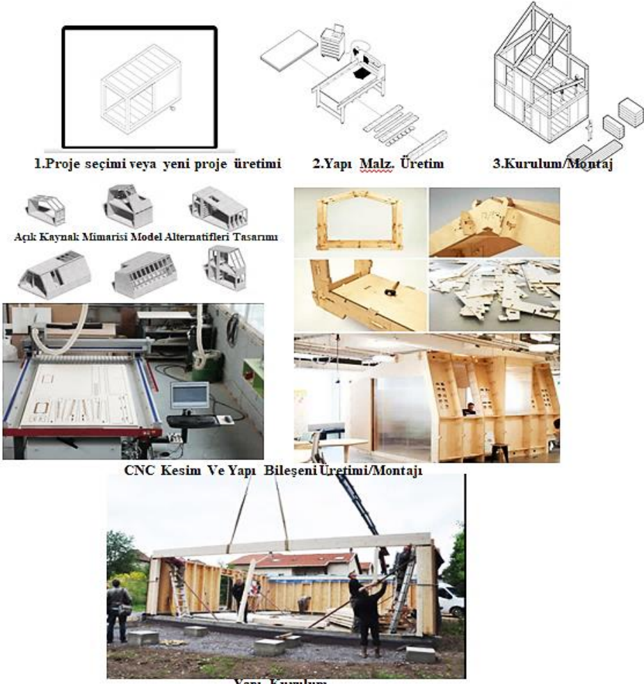
Şekil 13. Örnek açık kaynak mimarisi, yapı üretimi aşamaları (Wikihouse, 2019)
