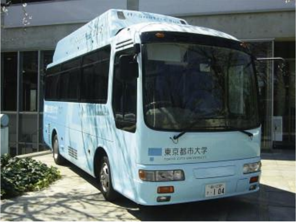
Şekil 8.3. Tokyo Şehir Üniversitesi tarafından gösterilen 4,7 L 105 kW hidrojen motoruyla donatılmış Microbus. Telif hakkı sahibi Tokyo Şehir Üniversitesi tarafından verilen çoğaltma izni.
