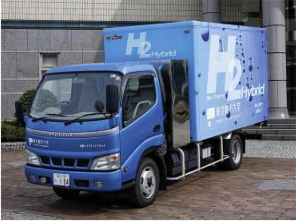
Şekil 8.2. Tokyo Şehir Üniversitesi tarafından gösterilen, 4 L 91 kW hidrojen motorla donatılmış hibrit hafif hizmet kamyonu. Telif hakkı sahibi Tokyo Şehir Üniversitesi tarafından verilen çoğaltma izni.
