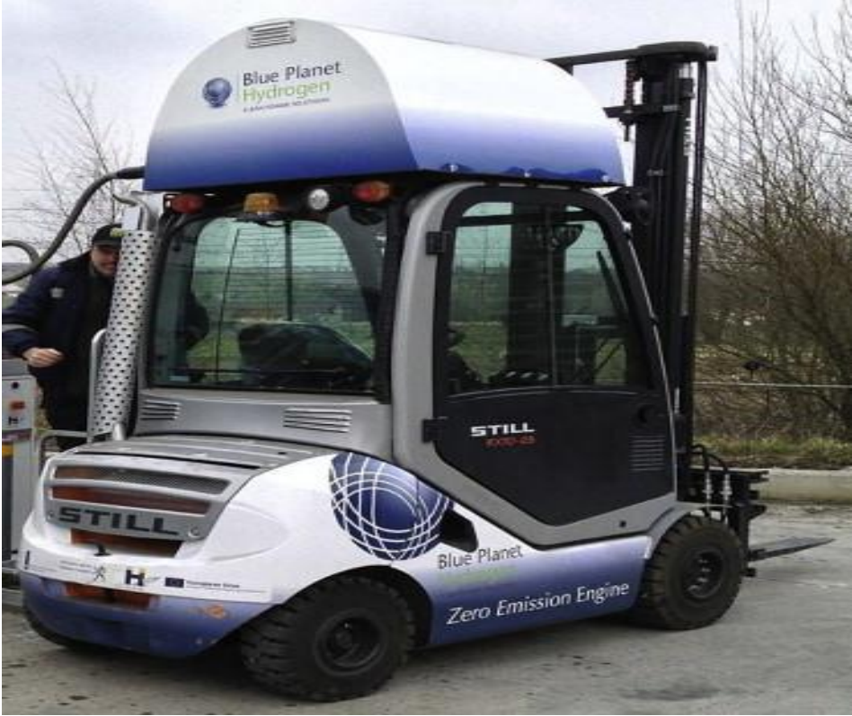
Şekil 8.1. Hidrojen Bölgesi Flanders – Güney Hollanda projesi kapsamındaki gösteri faaliyetlerinin bir parçası olan H 2 ICE ile donatılmış forklift kamyonu.
