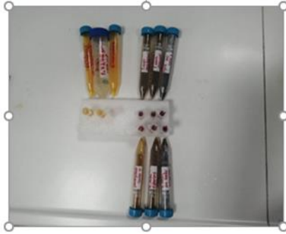
Şekil 4. 1 ve 2 mM lık \text{AgNO}_3 ile yeşil sentez reaksiyonuna giren çözeltilerde gözlenen renk değişimleri.
