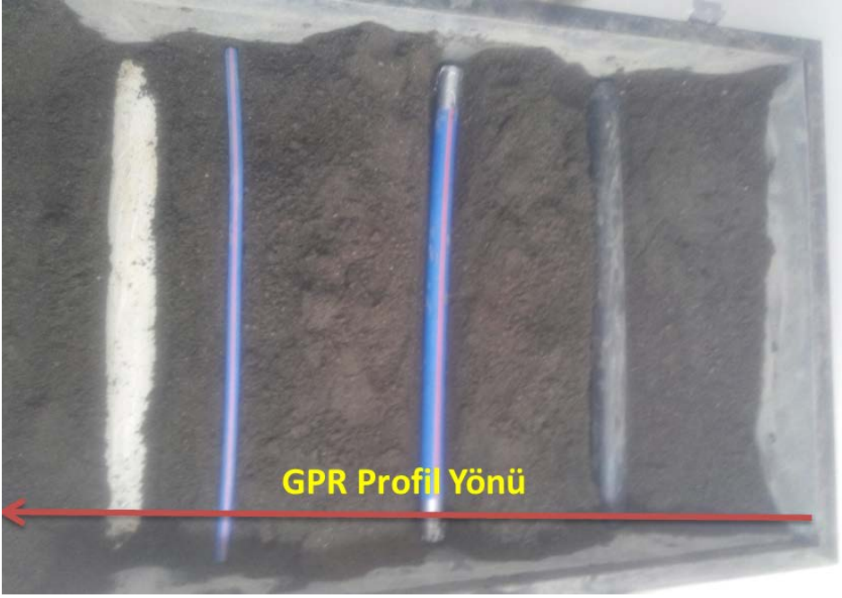
Şekil 3.20. Soldan sağa sırasıyla 100'lük PVC boru, 20'lik, 40'lık ve 63'lük kangal borularla oluşturulan laboratuvar model-5
