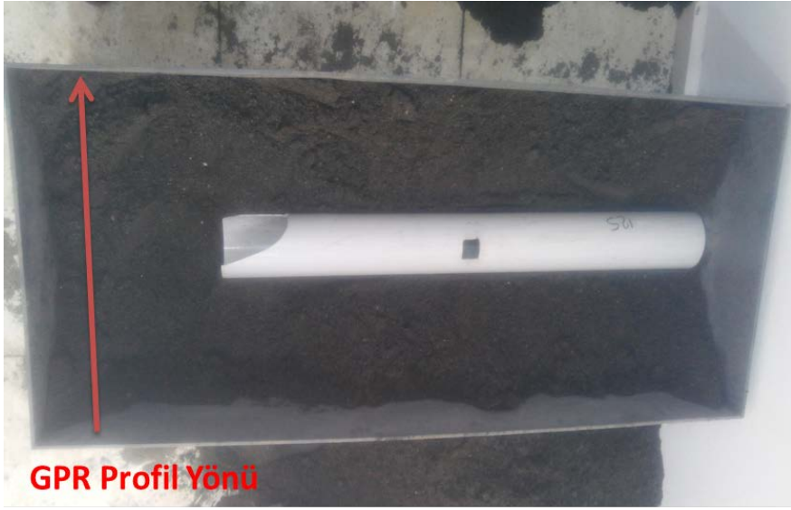
Şekil 3.33. Tıkalı ve delik 125'lik PVC boru ile oluşturulan laboratuvar model-9
