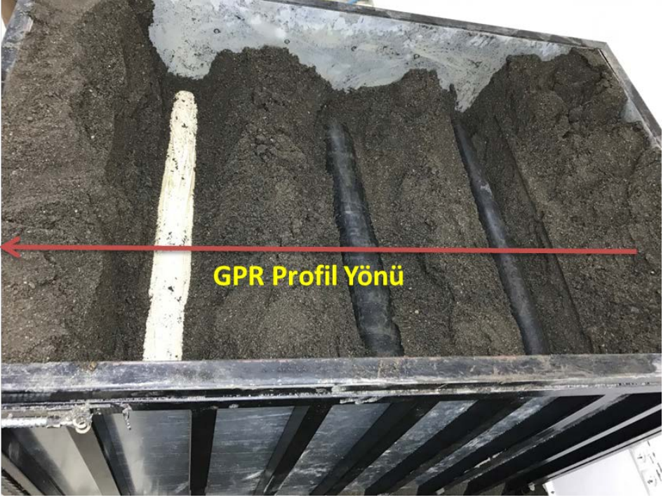
Şekil 3.24. Soldan sağa sırasıyla 100'lük PVC, 120'lik çelik ve 63'lük kangal borularla oluşturulan laboratuvar model-6
