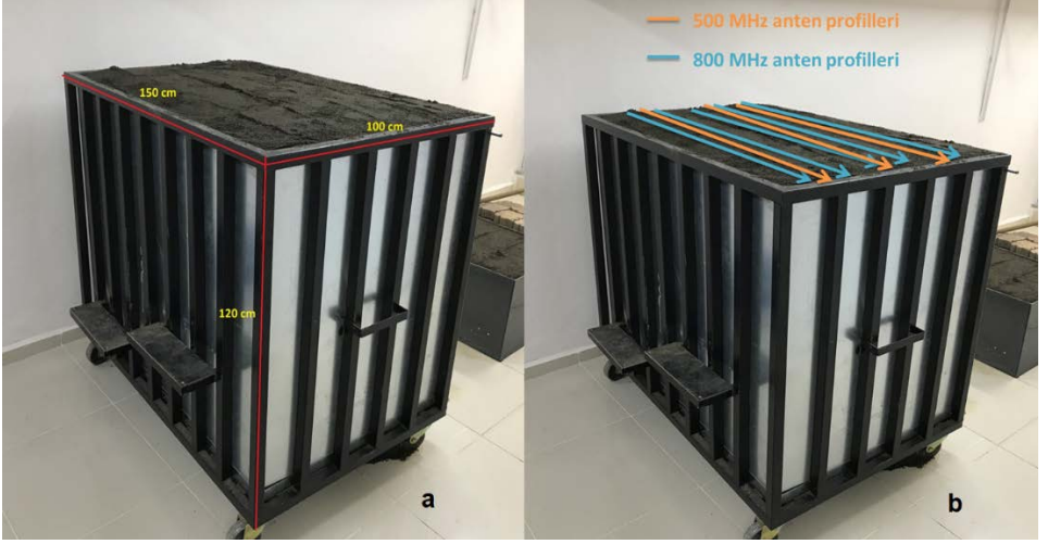
Şekil 2.6. a) Laboratuvar çalışmalarının yapıldığı metal deney sandığının ölçüleri ve b) 500 MHz ve 800 MHz antenler ile GPR ölçümlerinin alındığı profiller
