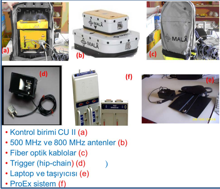
Şekil 2.5. GPR verilerinin toplanmasında kullanılan antenler ve sistemleri
