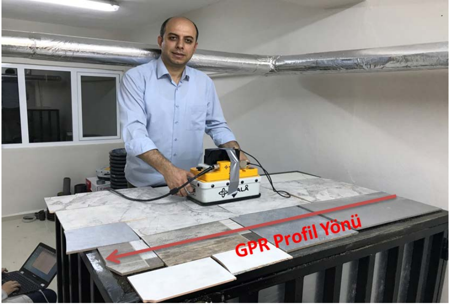
Şekil 3.8. Soldan sağa sırasıyla 150'lik, 300'lük ve 200'lük koruge borularla oluşturulan fayans kaplı laboratuvar model-2
