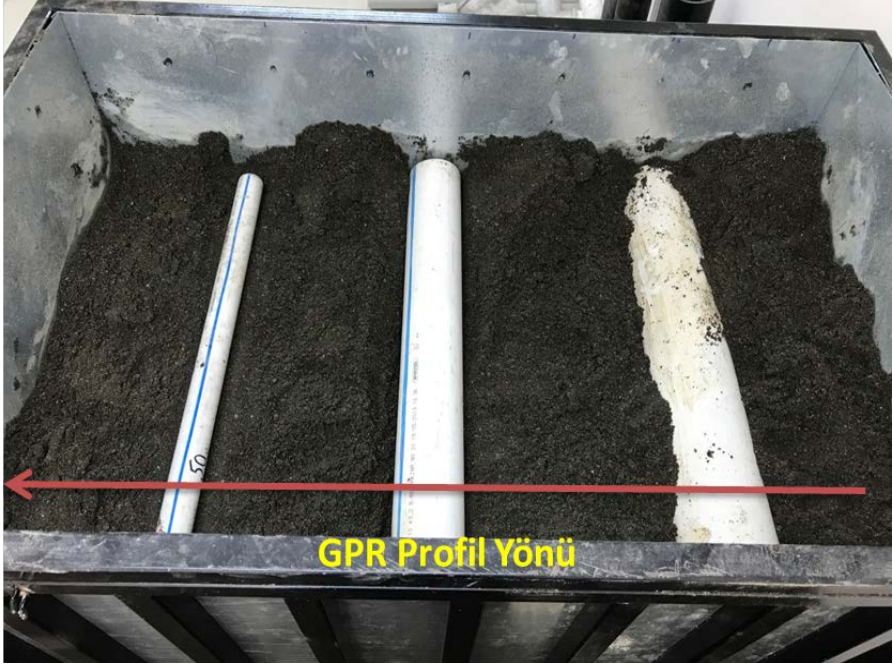
Şekil 3.12. Soldan sağa sırasıyla 50'lik, 100'lük ve 150'lik PVC borularla oluşturulan laboratuvar model-3
