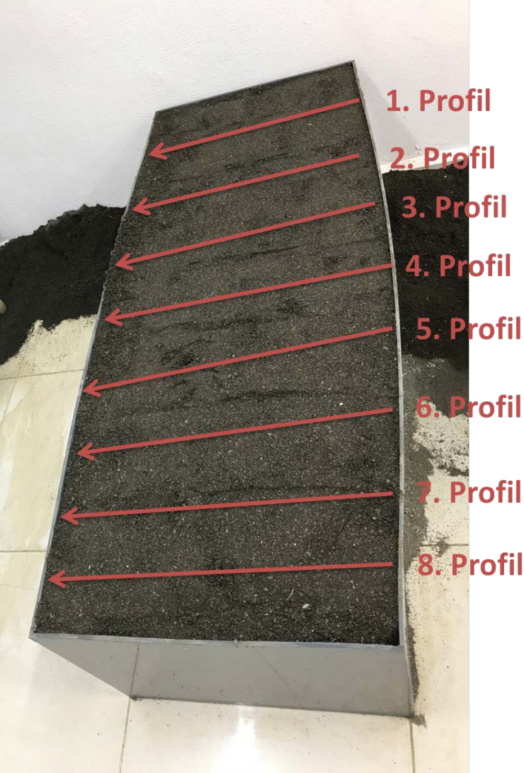
Şekil 3.2. Laboratuvar alıřmalarının yapıldığı plastik deney sandığında, 800 MHz anten ile GPR ölçümlerinin alındığı profiller
