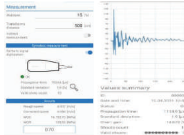
Şekil 9.7. Ultrasonik test yöntemi için kullanılan Sylvatest 4 cihazı yazılım sonuçları
