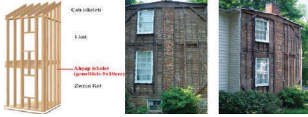
Şekil 4.11. a) Balon Karkas yapı kesiti [23] b) Balon Karkas örnek yapı [24]
