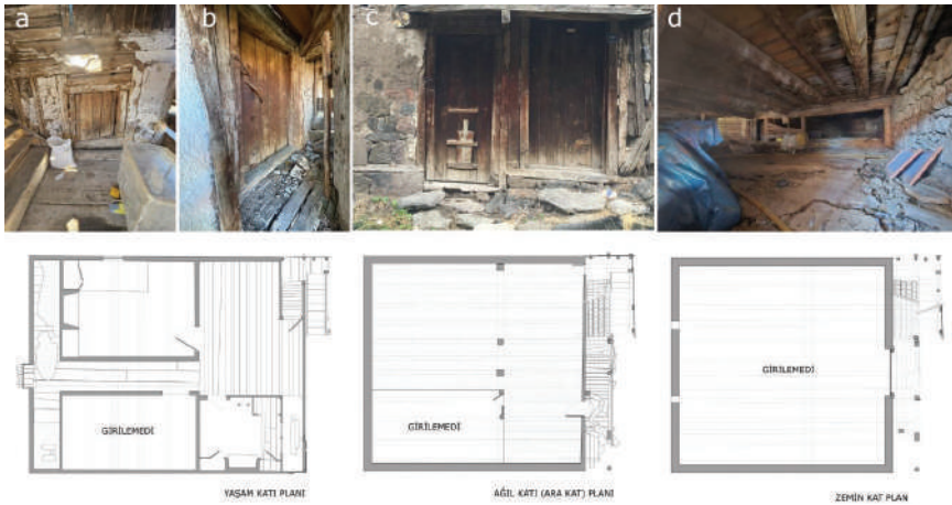
Şekil 16.3. Eğirdere köyünde tespit edilen ağıllı ve kümes kapıları (a-d), ara katı (ağıllı) bulunan konut planı örneği
