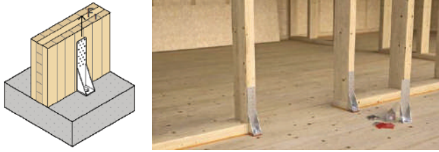
Şekil 7.10. Açılı braket zemin-panel birleşimi [47].
