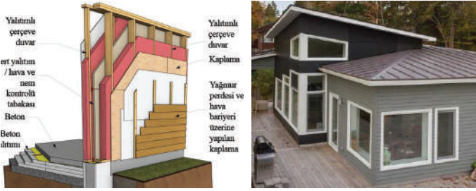
Şekil 10.8. Çift çerçeve duvar sistemi detayı (pasif ev) [64]
