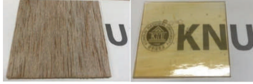
Şekil 2.1. (a) İşlem görmemiş ahşap (balsa ağacı) (b) Şeffaf ahşap [3]
