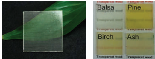
Şekil 6.1. Saydam ahşap [20]; Balsa, çam, huş ve dişbudak ağaçlarının saydam formu [21]
