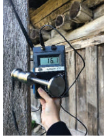
Şekil 9.9. İki elektrot arasındaki elektriksel dirençle rutubet ölçüm aparatı [7]
