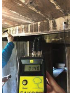
Şekil 9.6. Fakopp firmasına ait stres dalga ölçüm cihazı [7]
