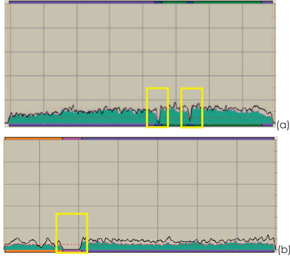
Şekil 9.3. Ahşap yapıların taşıyıcı elemanlarına delme (Rezistograf) cihazıyla yapılan incelemelere ait bazı grafikler [7]
