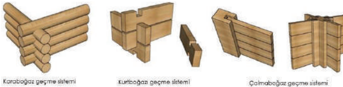
Şekil 4.14. Yiğma sistem köşe bağlantı türleri (yeniden çizilmiştir) [36]
